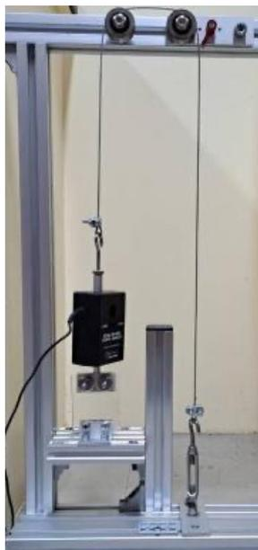
รูปที่ 1 การสร้างชุดอุปกรณ์สำหรับวัดความเค้น
