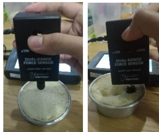
รูปที่ 3. ขนมปังปอนด์ขณะทดสอบแรงกระทำโดยใช้เครื่อง Datalogger
